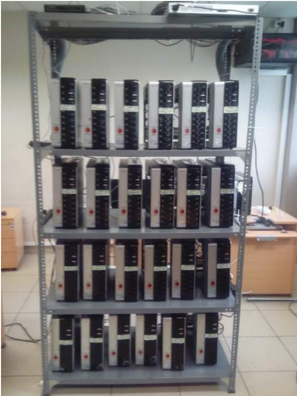
Figura 3. Clúster CTIC construido con PCs Core 2 Duo de 2.33 Gigahertz de 2 núcleos, 1 Gigabyte de RAM y 320 gigabytes de disco duro.
